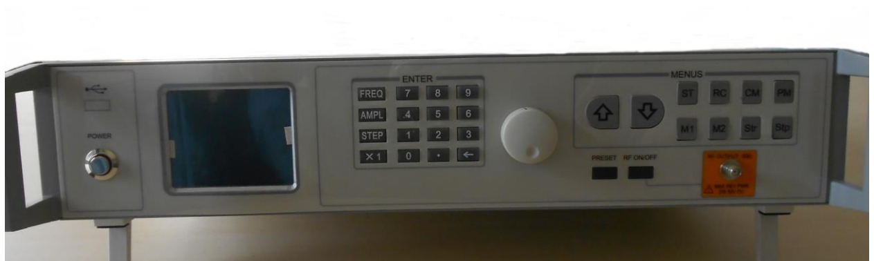
2、仪器外形图：八寸 19 英寸 2U 深 400mm 标准机箱。可直接安装在 19 英寸的机架上。
